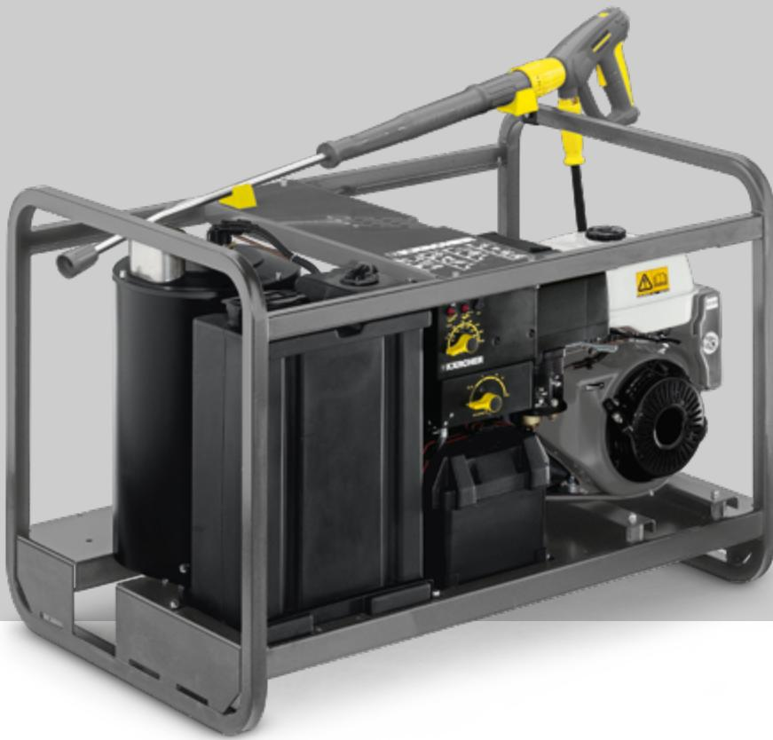
Equipada com recursos abundantes e um potente motor a diesel, sua estrutura é robusta, e a bomba com cabeçote de cilindro de latão, válvulas de aço inoxidável e pistões revestidos de cromo-níquel garantem uma vida útil extremamente longa, mesmo em uso contínuo e desafiador. Segura, conta com proteção contra calcificação integrada, válvulas de segurança e proteção contra falta de óleo, água e combustível, o que também permite a disposição da máquina a qualquer momento.
